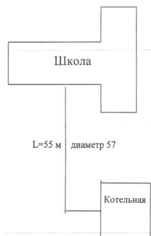
Рисунок 3.2. Схема теплотрассы котельной в с. Полудни по адресу ул. Солнечная, 1б.
