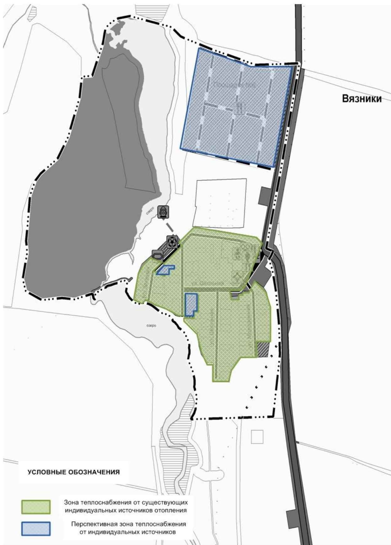
Рисунок 2.2.4 – Зоны действия систем теплоснабжения п. Вязники
