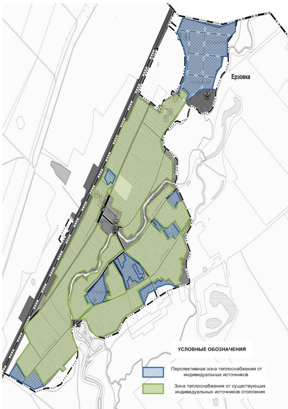
Рисунок 2.2.1 – Зоны действия систем теплоснабжения с. Ерзовка
