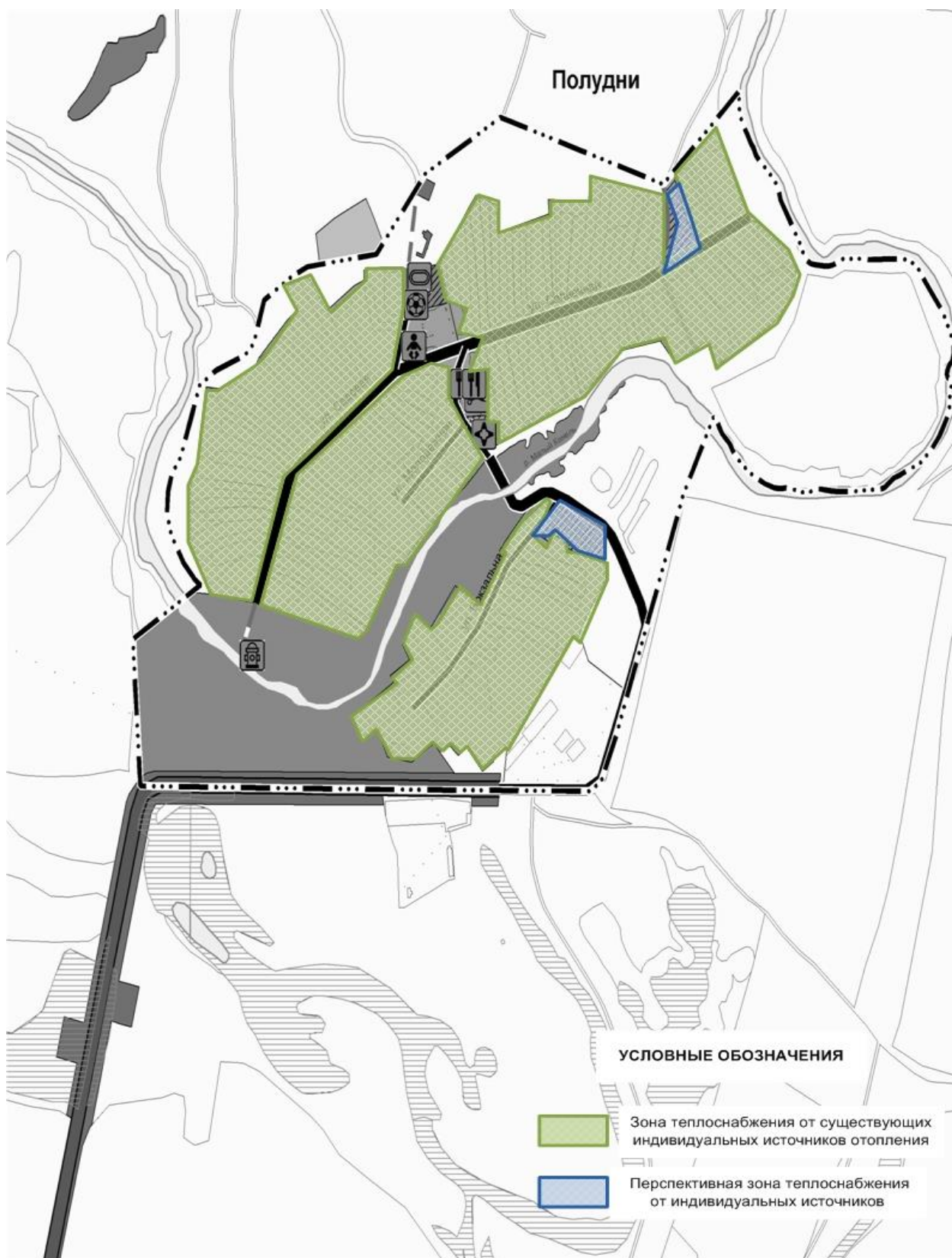
Рисунок 2.2.3 – Зоны действия систем теплоснабжения с. Полудни
